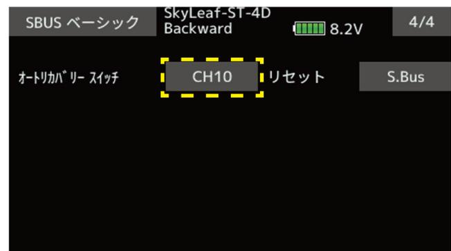
5. 「SBUS ベーシック」 ボタンを押して、SBUS ベーシック設定を終了します。次にベーシックメニュー画面の「設定」ボタンを押します。設定メニューの1ページ目が表示されます。設定メニューは9ページ有ります。
