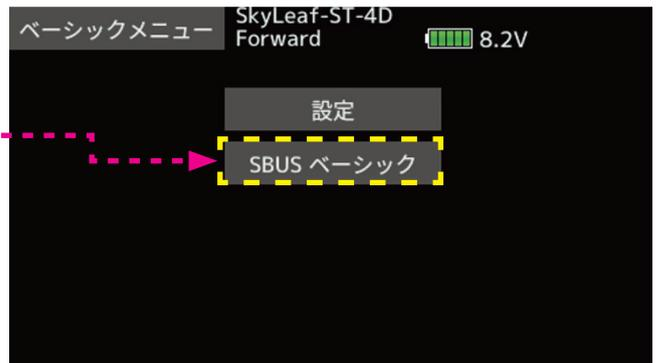
4. 「SBUS ベーシック」 ボタンを押して、SBUS チャンネルの設定を行います。AIL2,ELE2,RUD2 は未使用ですので、「INH」に設定します。保持力及び4Dフライト(ジャイロリバース)チャンネルは「CH12」に設定します。オートリカバリーチャンネルは「CH10」に設定します。
