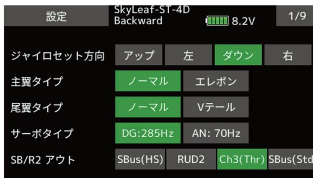
6. 2 ページ目は、ジャイロの動作方向を設定します。動作方向は、機体が前進時の設定を行います。機体のエルロン（ロール）、エレベーター（ピッチ）、ラダー（ヨー）の動作方向に対して、ジャイロの動作が逆方向に制御することを確認してください。ジャイロ動作方向の確認は、送信機の設定が完了してから行います。7 項以下も動作確認は同じく送信機の設定が完了してから行います。
