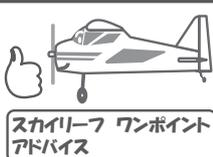
動力バッテリーは使う種類によって重量がちがうので、最後に指定の重心位置になるように、搭載する位置で調整しよう！
