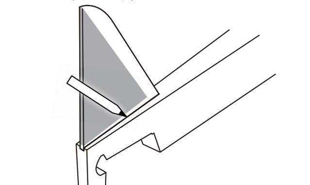
**2** ● 付けた印にそって垂直尾翼の胴体への差し込み部分のフィルムをカットします。
