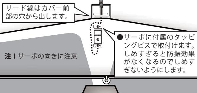
● サーボに付属のタッピングビスで取付けます。しめすぎると防振効果がなくなるのでしめすぎないようにします。
