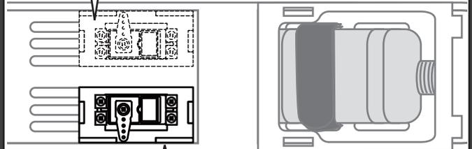
●側板にサーボマウントを瞬間接着剤で接着します。
