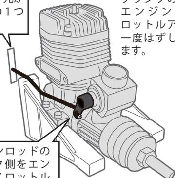
●エンコンロッドのクランク側をエンジンのスロットルに接続します。
