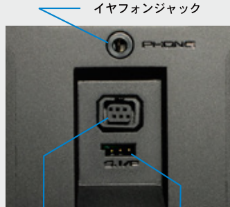
イヤホンジャック トレーナー用コネクター S.BUSサーボ設定用コネクターポート
