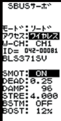
プログラマブルサーボの特性変更を4PM送信機本体で出来ます。(ワイヤレス設定可能)
