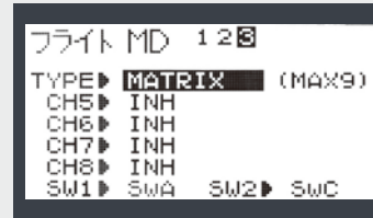
新たにフライトモードが追加され、最大9種類のフライトモードが設定できます。
