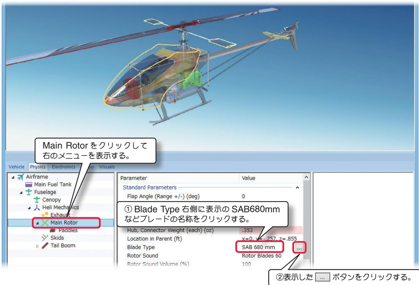
現在のローターブレード・セッティングデータには次の方法でアクセスします。
