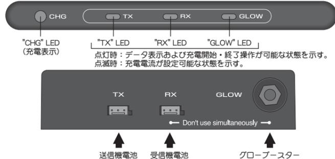
充電する電池のタイプに合った出力コネクタに接続します。"TX"、"RX"、または"GLOW" LEDの内、対応したLEDが点灯します。また、自動的に充電電流の設定画面 (カレントセット画面) が表示されます。
