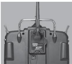
2 電源スイッチを ON にすると送信機本体側は自動認識により周波数帯が 2.4GHz に切り替わります。R6014HS 受信機を使用する場合は、送信機の初期画面で右上の表示が 2.4GHz-10CH モード ("2.4GHz 10CH") に
