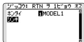
2. RTNボタンを長押し(1秒)します。(中止する場合はプッシュダイヤルをスクロール操作するか、S1ボタンを押します。)
