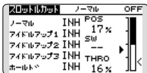
ただし、安全のため、スロットル・ステイックがスロー側 25% より下側のときにのみ、エンジン・カット機能が働きます。
