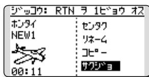
4. RTNボタンに長押し（1秒）すると、モデルが削除されます。（中止する場合はプッシュダイヤルをスクロール操作するか、S1ボタンを押します。）
