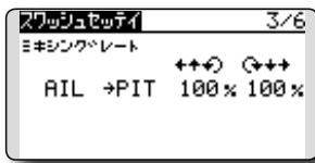
エルロン・ステイックを左右に振ったとき（スロットルはニュートラルポイント）、エレベータまたはピッチ方向に干渉しないよう、AIL → PIT 量を調整します。
