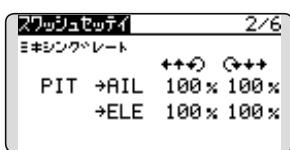
スロットルステイックを、最スロー、フルハイと動かしたとき、スワッシュプレートが水平に動くように、PIT → AIL、PIT → ELE 量を調整します。
