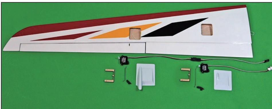
通してある紐に延長コードを取付けリブに引っかからないようにコードを通します。コードと紐の繋がる部分にクサビ形にセロテープを巻くと通し易くなります。
