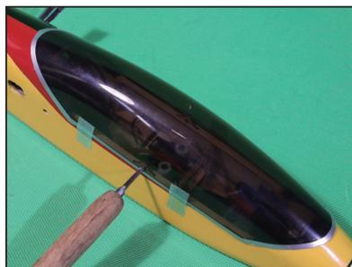
キャノピーをピンで固定します。キャノピーはカットラインより大きい目に切り取り、微調整しながら大きさを合わせて下さい。位置を合わせ、ピン穴に合わせて穴を開けます。※キャノピーが冷たい時に作業しないで下さい。冷えていると割れる事があります。
