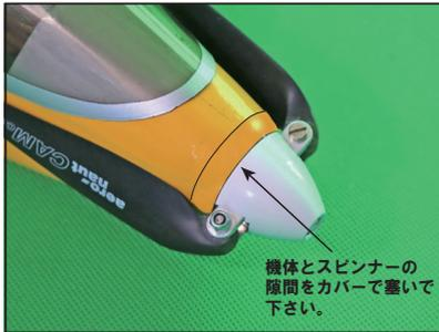
機体とスピナーの隙間をカバーで塞いで下さい。
