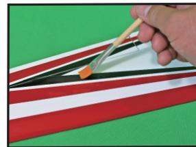
フィルムは顔料で固定されてます。顔料がゴミやオイル、ワックスに侵されるとフィルムが剥がれる原因となります。塗料を塗る事により端面が保護され美しさが維持されます。
