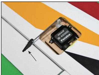
S-AG300サーボの場合は横積みサーボベットのタッピングで固定し、ホーン、ロッド、カバーの位置を確認の上サーボベットに瞬間接着剤を流し固定します。エルロンホーンをロッドに接続後にエルロンに接着します。
