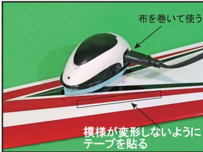
フィルムは軽く熱をかけて貼ってます。弛みがある場合はアイロンで熱を加えながら押さえて下さい。模様の継ぎ目部分はセロテープなどで模様が熱で変形しないように対策してから熱を加えてください。
