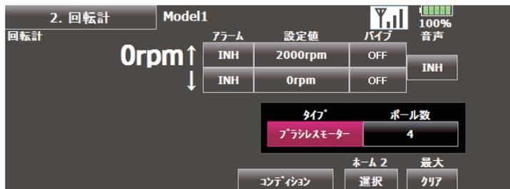
■ SBS-01RB をご使用の場合は、回転計表示画面の「タイプ」ボタンで「ブラシレスモーター」を選択します。また、「ポール数」にご使用のモーターのポール数（極数）を設定してください。
