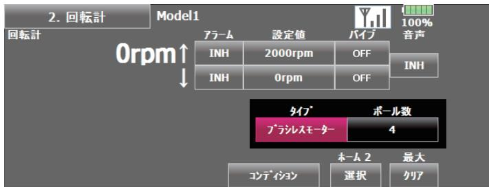
■ SBS-01RBをご使用の場合は、回転計表示画面の「タイプ」ボタンで[ブラシレスモーター]を選択します。また、「ポール数」にご使用のモーターのポール数(極数)を設定してください。
