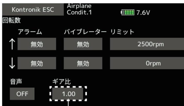
ギアダウンしている場合はギヤ比を入力するとヘリのローター回転数、飛行機のギヤダウンしたプロペラ回転数が表示されます。
