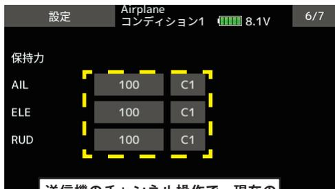
送信機のチャンネル操作で、現在のレートナンバー C1 ~ C5 を表示し、調整することもできます。
