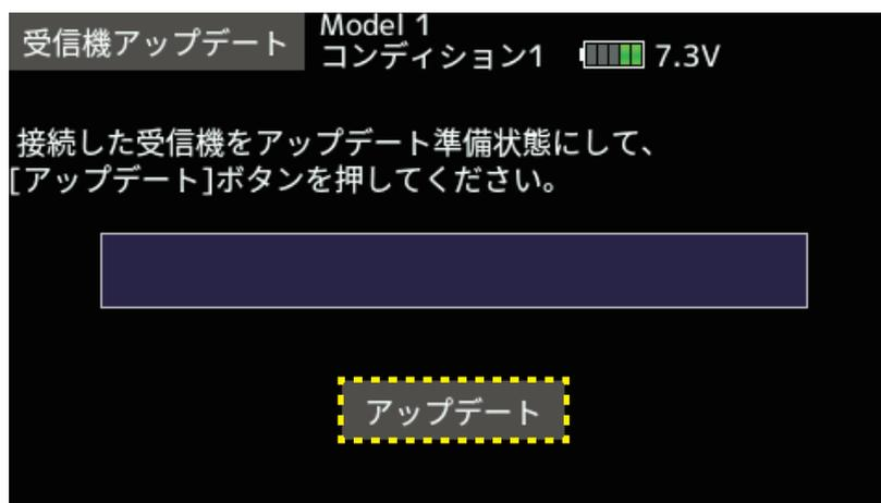
13. アップデートが完了すると、R7201SB/R7301SB の緑 LED が点灯します。
