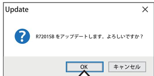
12. アップデートが開始されます。アップデート中は、PCソフトのUpdateのバーグラフが進行し、R7201SB/R7301SBの緑LEDがチラチラと点滅します。
