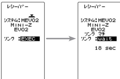
4. RA-51 のリンクスイッチを 2 秒以上押した後、離し、LED が 2 秒点灯ののち、再度点滅したら、T4PM PLUS のリンクモードを解除し、通常モードにしてください。
